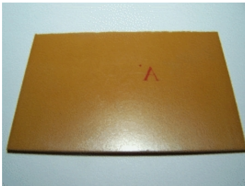
Placa de circuito impreso parte baquelita
