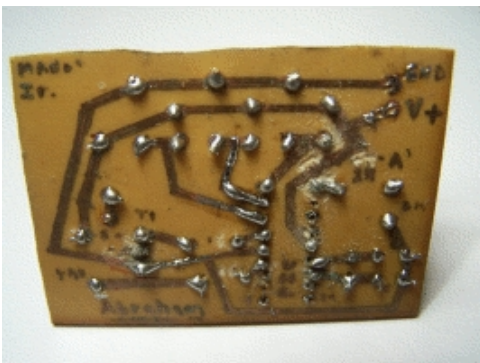
Placa de circuito impreso parte baquelita
